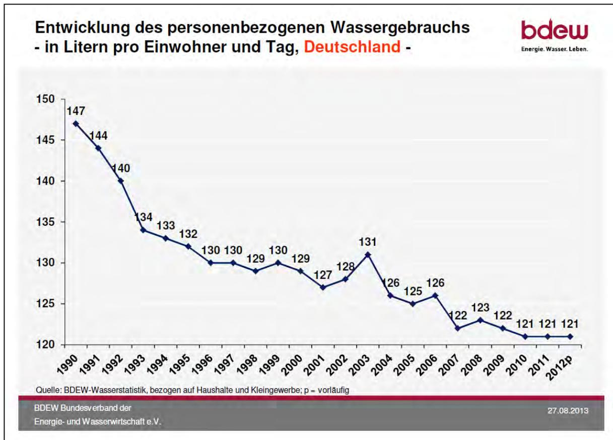
**Abbildung 3-3: Entwicklung des spezifischen Wasserverbrauchs [ l / E x d ] BRD**
